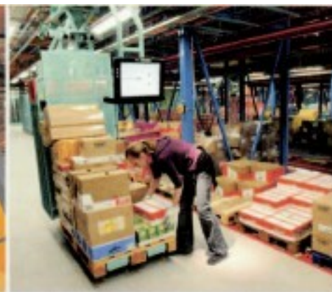
Kommissionierung per CaddyPick: Die Ware wird manuell dem Kommissionierfahrzeug übergeben und von diesem zum Warenausgang befördert.
