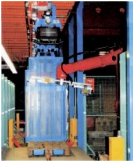
Hightech wie in der Automobilindustrie: Moderne Industrieroboter nehmen die Leerpaletten ab.
