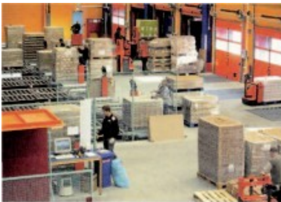
Die per Lkw angelieferten Euro- oder Chep-Paletten werden manuell entladen, auf die 16 angetriebenen Rollenbahnen im Wareneingang abgesetzt und ihr Gewicht gewogen.
